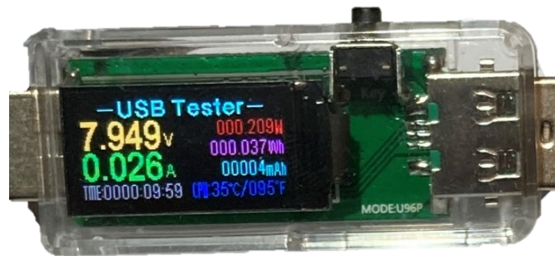
Obrázek 23 Měření odběru Arduina napájeného 9 V baterií
