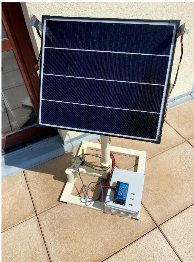
Obrázek 32 Zkonstruovaný fotovoltaický otočný systém
