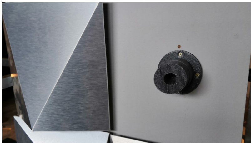
Obrázek 34 – Spojka s dutinou pro magnet
