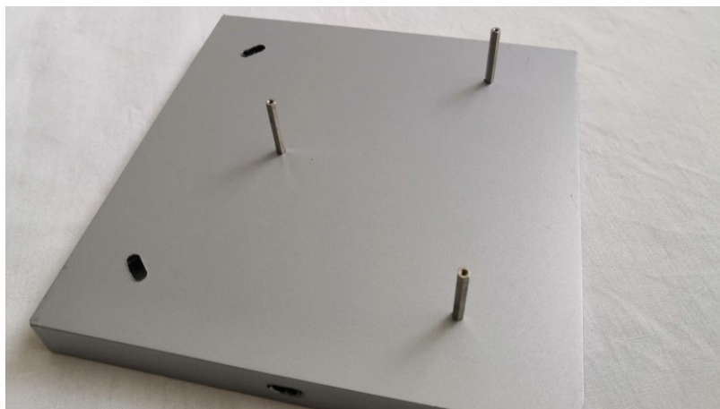
Obrázek 37 – Základna s distančními sloupky a otvory pro kabeláž
