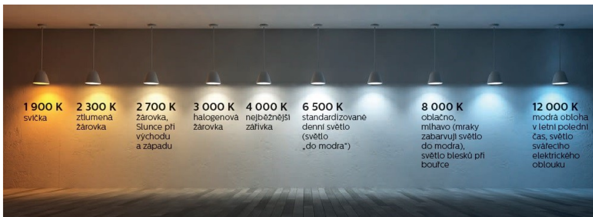
Obrázek 15 – Příklady barvy světla odlišných stupňů Kelvina [46]
