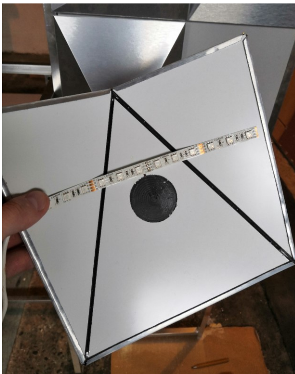
Obrázek 26 – Odfrézování vrchní vrstvy hliníku
