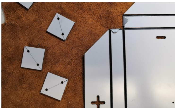
Obrázek 40 – Upravené rohy a přidané kusy k snýtování základny
