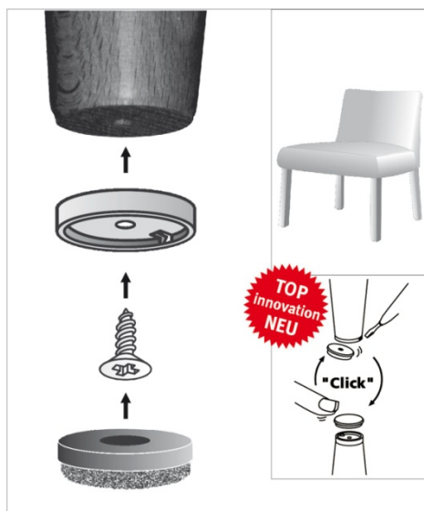
Obr.13 QuickClick základní díl k přišroubování, (zdroj: webshop.schachermayer.com )
