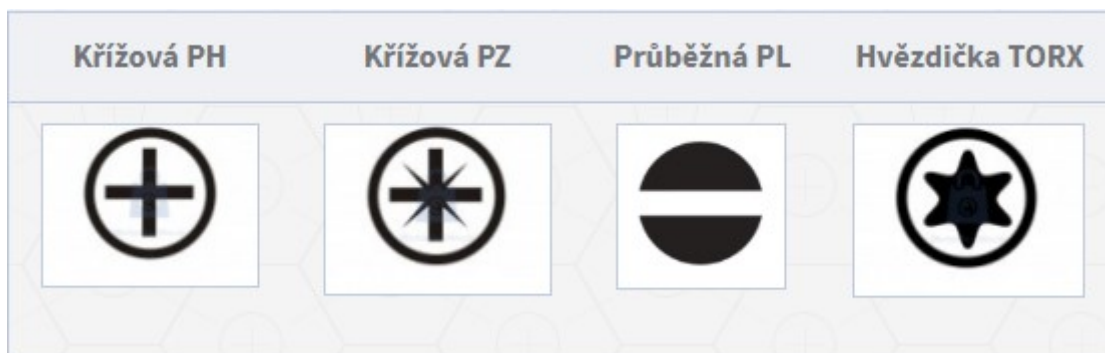
Obr.8 Drážky vrutu, (zdroj: obchodprodilnu.cz)
