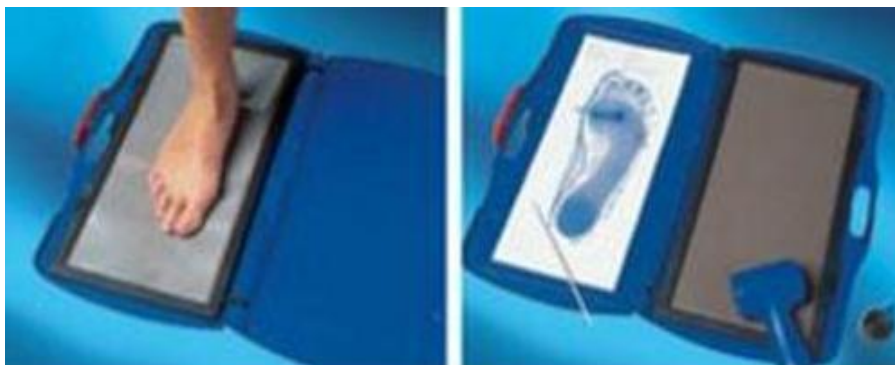
Obr. 5. Snímání otisku a obrysu nohy pomocí plantografu [10]
