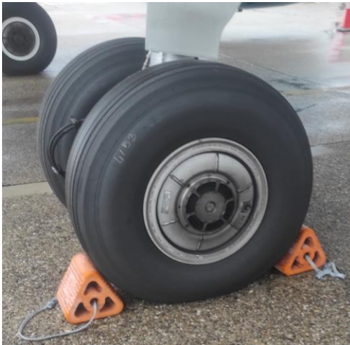
Obrázek 11 Zabezpečení letadla proti pohybu (vlastní)
