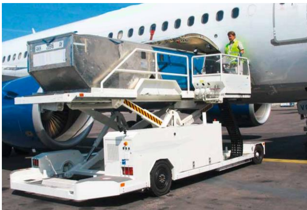
Obrázek 9 Loader transporter a ULD pro A320-214 (Aviationgse.com)
