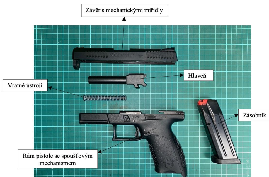
Obrázek 28 Popis hlavních částí pistole CZ P-10 C, (vlastní, 2024)
