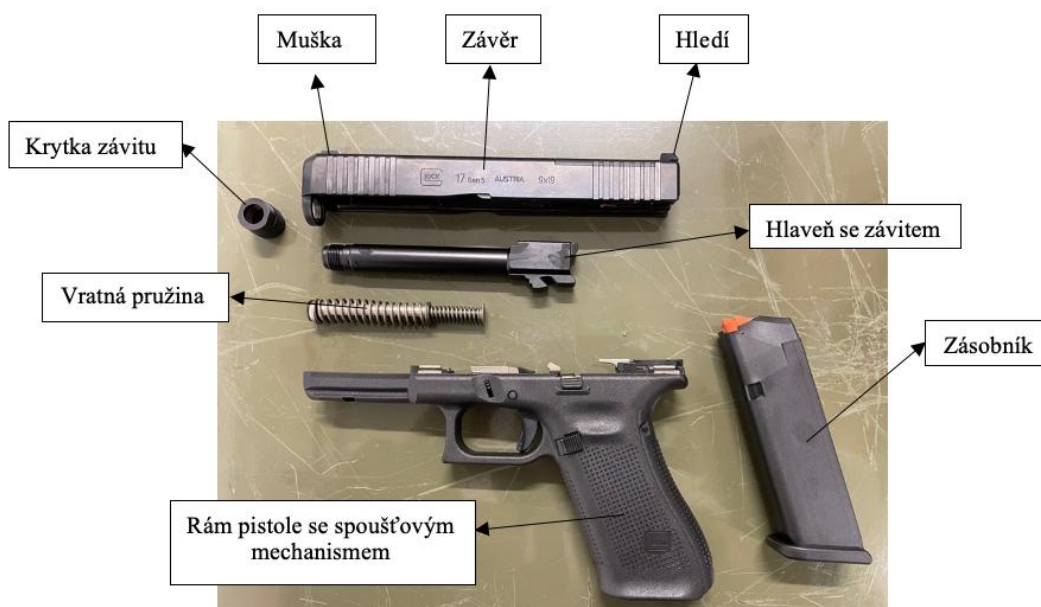
Obrázek 29 Popis hlavních částí pistole Glock 17 Gen5 MOS, (vlastní, 2024)
