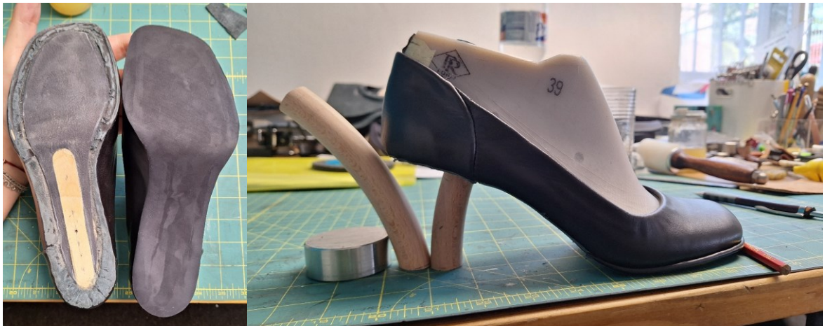
Obrázek 50: Dřevěný klének a umístění podpatku ( autorské fotografie, 2024 )
