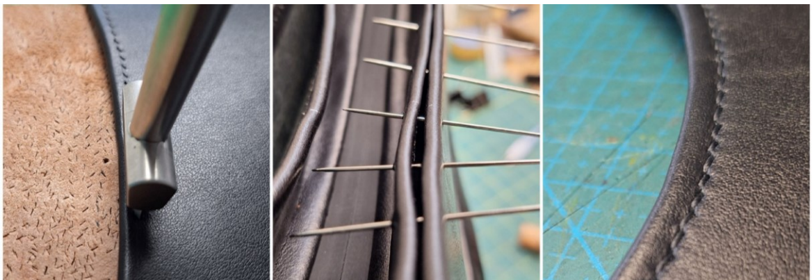
Obrázek 43: Postup ručního šití kabelek ( autorské fotografie, 2024 )
