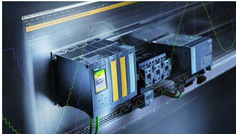
Obrázek 3 Modulární PLC S7-1500 [5]
