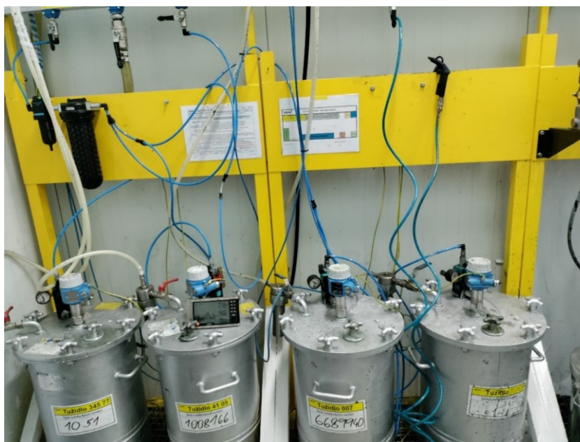
Obrázek 15 Tlakové zásobníky tvrdidel [vlastní]
