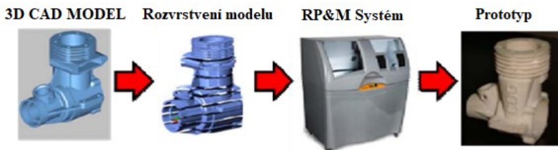
Obrázek 20 Proces výroby produktu pomocí technologie RP [51]
