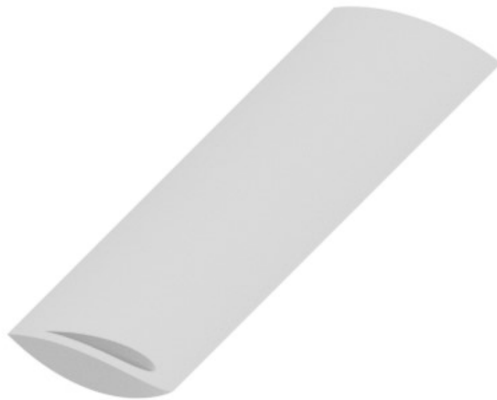
Obrázek 25 3D Model navržené výztuhy s tvarovým otvorem pro uchycení lopatky
