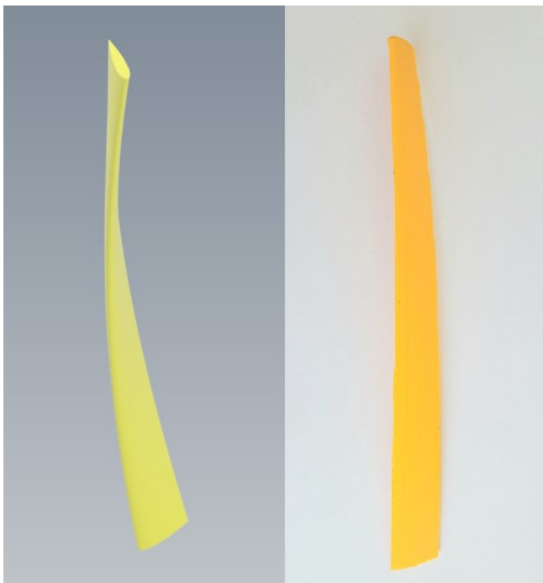
Obrázek 39 3D model a vytisknutý prototyp lopatky NACA 0018
