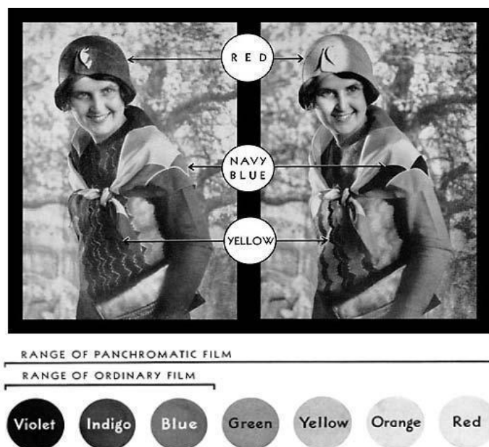
Obr. 18 - Ukázka citlivosti panchromatického a ortochromatického filmu na barevné spektrum světla. Vlevo ortochromatický, vpravo panchromatický film.
