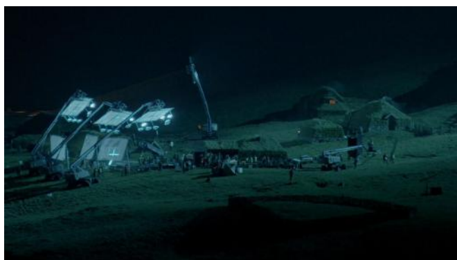
Obr. 29 - Foto z natáčení - svícení nočních exteriérů. Vlevo je patrné několik rámců narigovaných na plošinách s odraznou výplní spolu s množstvím světel Arri Skypanel. Sestava slouží jako doplňkové světlo, hlavní ostré světlo (18kw Arri do parabolického zrcadla) přichází z prava.
