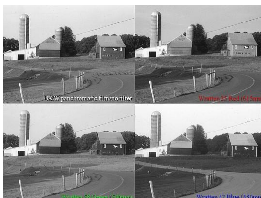
Obr. 19 - Ukázka filtrů (25 Red, 58 Green, 47 Blue) a jejich vlivu na obraz.
