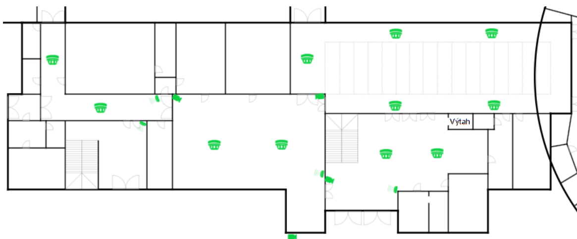
Obrázek 2 - Současný stav zabezpečení hlavní budovy – přízemí
