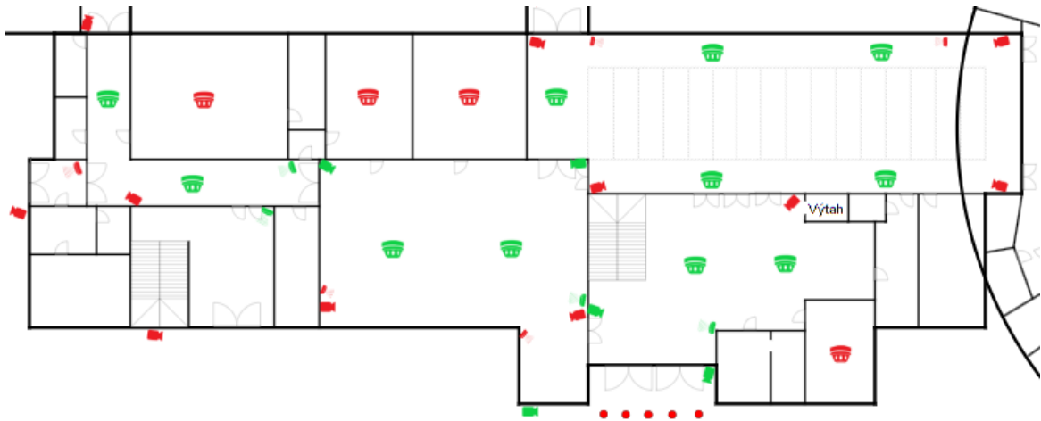
Obrázek 11 - Navrhované prvky zabezpečení hlavní budovy – přízemí (Vlastní, 2024)
