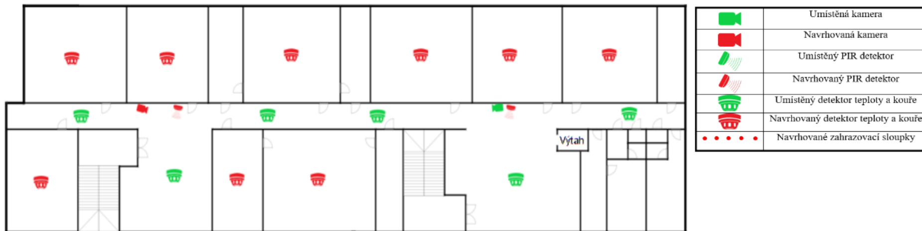
Příloha 3 - Rozložení bezpečnostních prvků - 2. a 3. patro (Vlastní, 2024)
