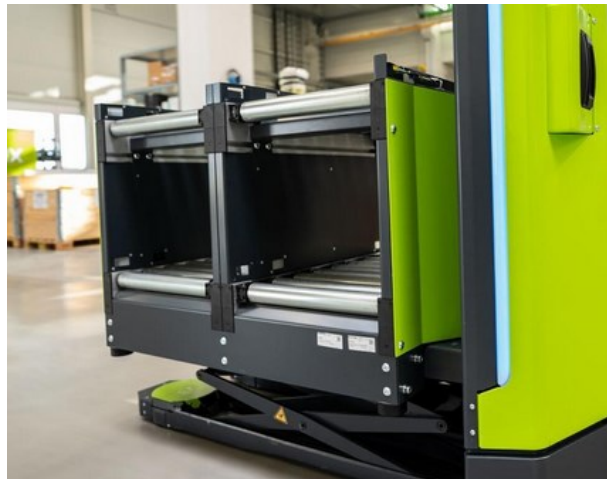
Obrázek 16 Modul na převoz krabic (AGILOX Services GmbH, 2022)
