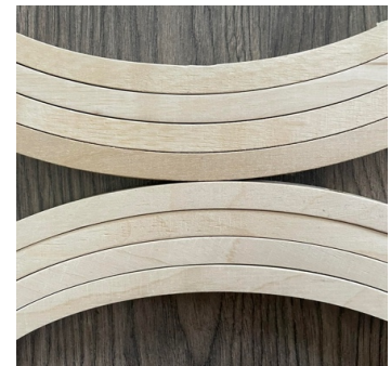
Obr. 174 Rozdíly před a po broušení
