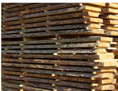
Obr. 80 Přirozené vysoušení masivního dřeva
