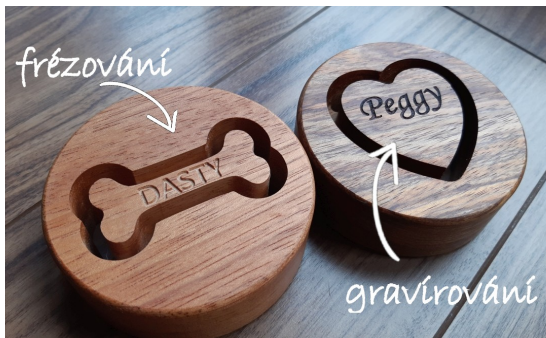
Obr. 103 Rozdíly mezi frézováním a gravírováním
