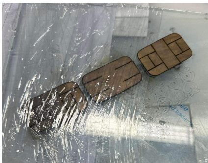
Obr. 157 Střih mosazného kříže z laseru
