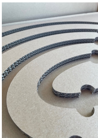
Obr. 214 Vnitřní vrstvení lepenky
