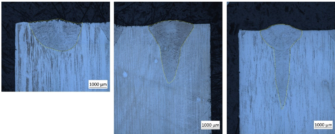
Obr. 54 Porovnání svarů při I = 20 mA, zleva I_F = 682 mA, 696 mA a 706 mA
