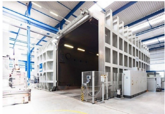
Obr. 17 Stolní svářečka a největší svářečka s pracovní komorou o objemu 700 m 3 [23; 24]
