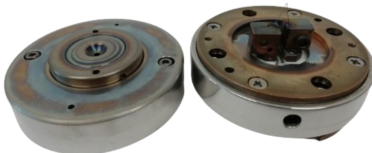
Obr. 23 Rozmontovaný držák katody během její výměny
