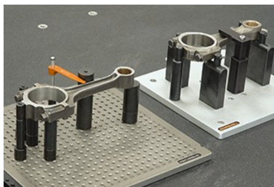
Obrázek 8: Upnutí dílu (Zdroj: renishaw.com)
