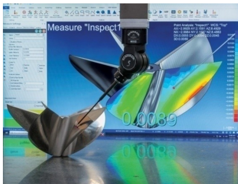
Obrázek 5: Kontrola součástky pomocí CMM (Zdroj: qualitymag.com)
