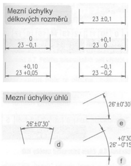
Obrázek 2: Geometrické tolerance a mezní úchytky délkových rozměrů a úhlů (Zdroj: Bílý, 2017; (MIKON TOOLS, online; IS.MUNI.CZ, online)
