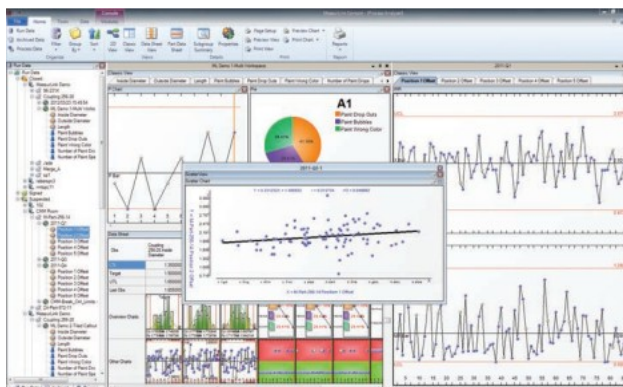
Obrázek 4: Příklad zpracování naměřených dat například z CMM v MeasurLink Process analyzeru (Zdroj: measurlink.com)
