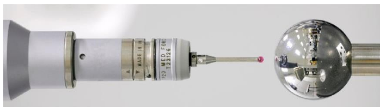
Obrázek 9: Kalibrace doteku pomocí kalibrační koule (Zdroj: Renishaw.com)
