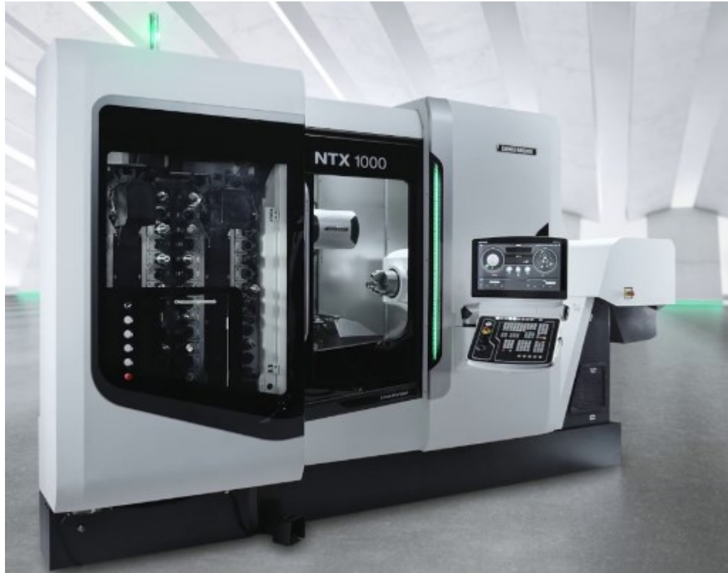
Obrázek 29 Obráběcí centrum NTX 1000 DMG MORI [29]
