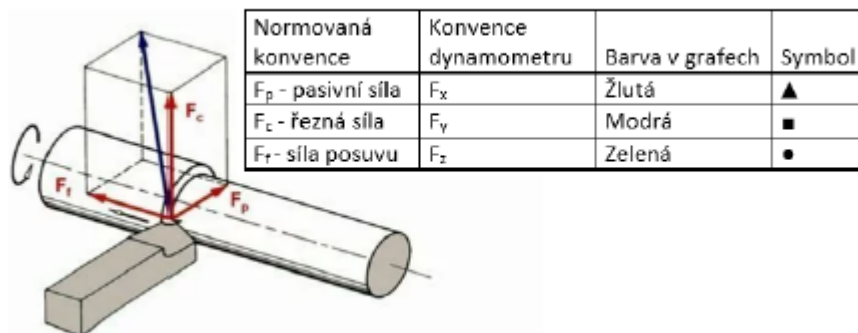
Obrázek 38 Schématické složky řezných sil
