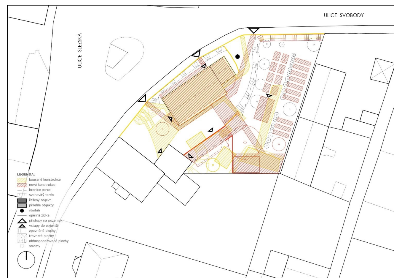
Obrázek 29 Bourané konstrukce v exteriéru
