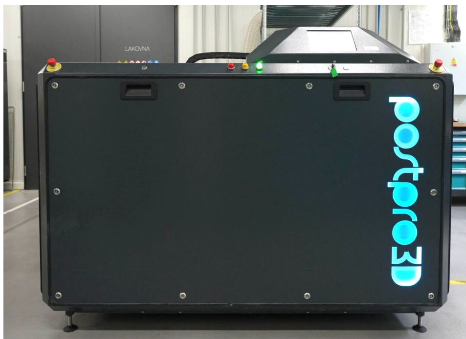
Obrázek 15 – Zařízení pro chemické vyhlazení povrchu dílů AMT PostPro3D (vlastní zpracování)
