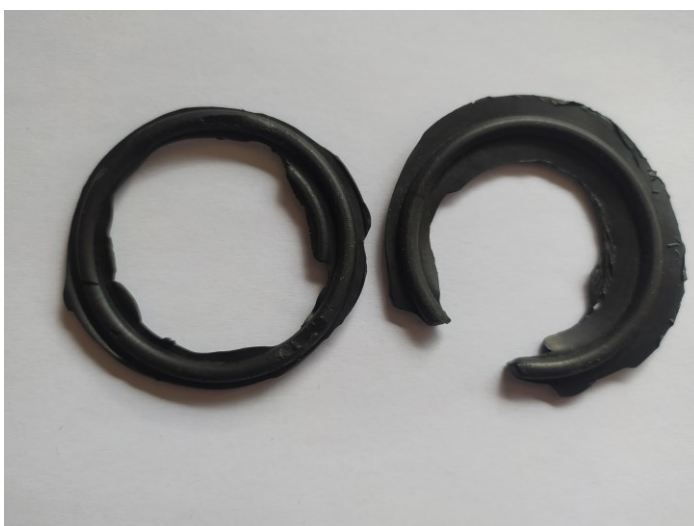
Obr. 30 Defekty kroužků připravených ve vulkanizační formě
