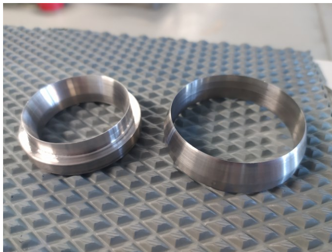
Obr. 31 Dělené nože vyrobené pro účely diplomové práce
