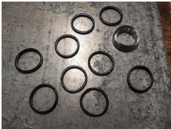
Obr. 32 Navážka kaučukové směsi tvaru mezikruží připravené pomocí vysekávacích nožů
