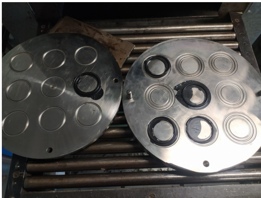
Obr. 29 Kroužky po vulkanizaci ve formě
