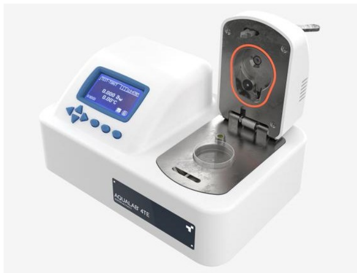
Obrázek 15: AquaLab 4TE s otevřenou měřicí komorou a vloženou vzorkovnicí. [83]
