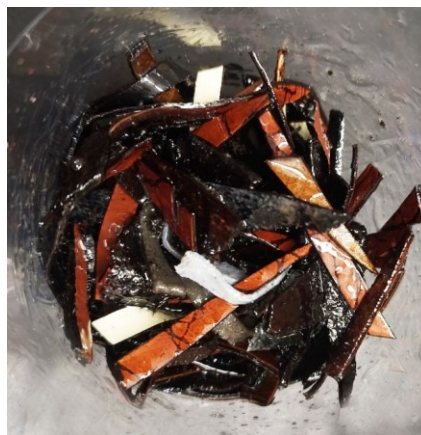
32: Smíchaná useň s plant-based epoxy
