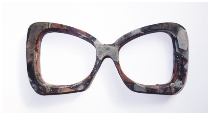
41: Rámy vyfrézované CNC strojem
