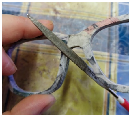
49: Pilování diamantovým pilníkem
