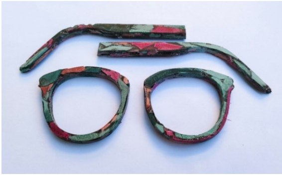
46: Obroušené brýle s nežádoucími otvory
