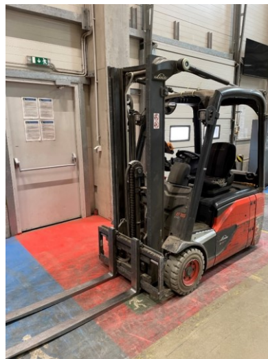
Obrázek 11-Čelní elektrický vysokozdvizný vozík (vlastní)
