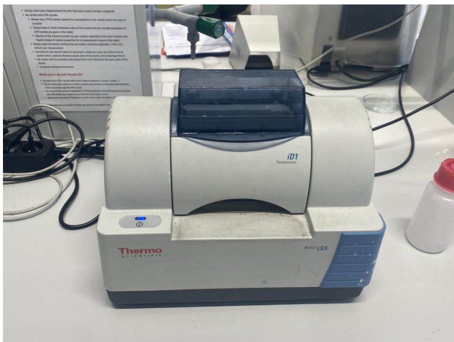
Obrázek 9 FT-IR spektrometr Nicolet iS5 (Thermo Fisher Scientific Inc., USA)
