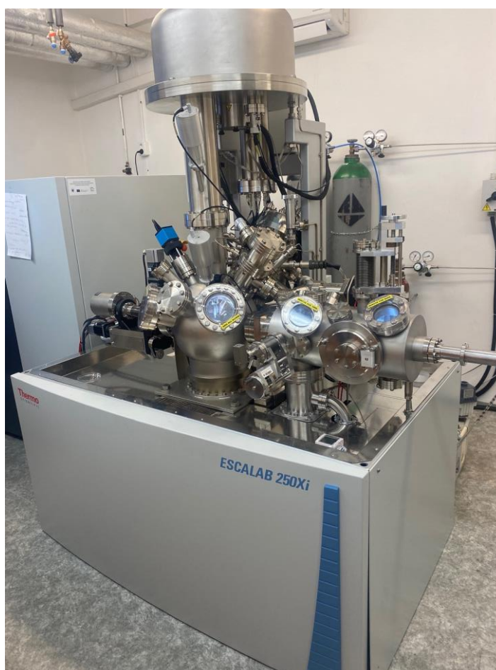
Obrázek 14 Rentgenový fotoelektronový spektrometr (XPS) ESCALAB 250Xi (Thermo Fisher Scientific Inc., USA)
