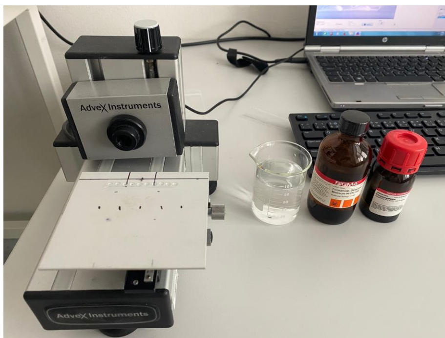
Obrázek 11 SEE systém (Advex Instruments, s.r.o., Česká republika)
