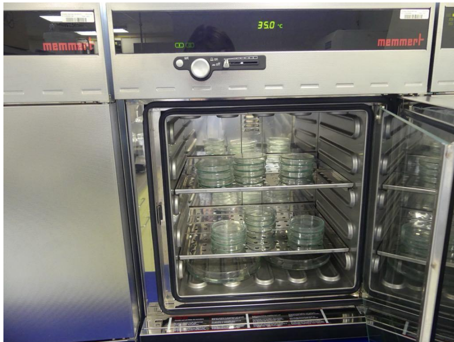
Obrázek 16 Horkovzdušný inkubátor Memmert INB 400 (Mettmert GmbH + Co. KG, Germany)
