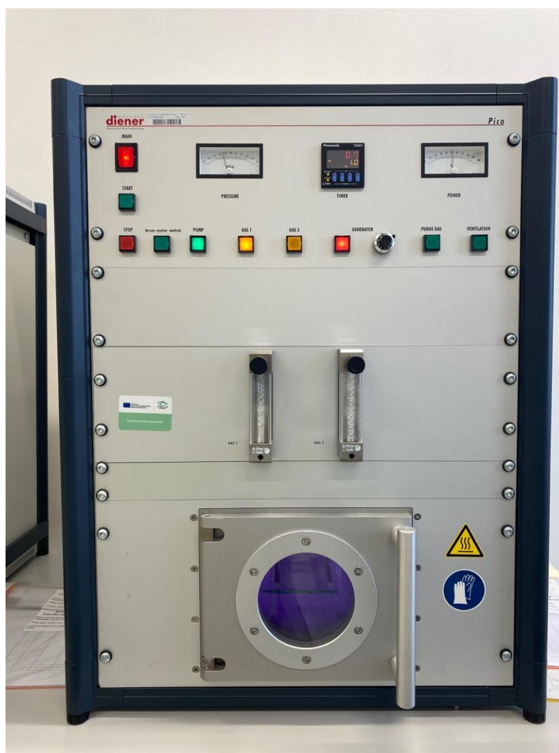
Obrázek 7 Vysokofrekvenční (40 kHz) plazmový reaktor Diener Pico (Diener electronic GmbH & Co. KG, Německo)
