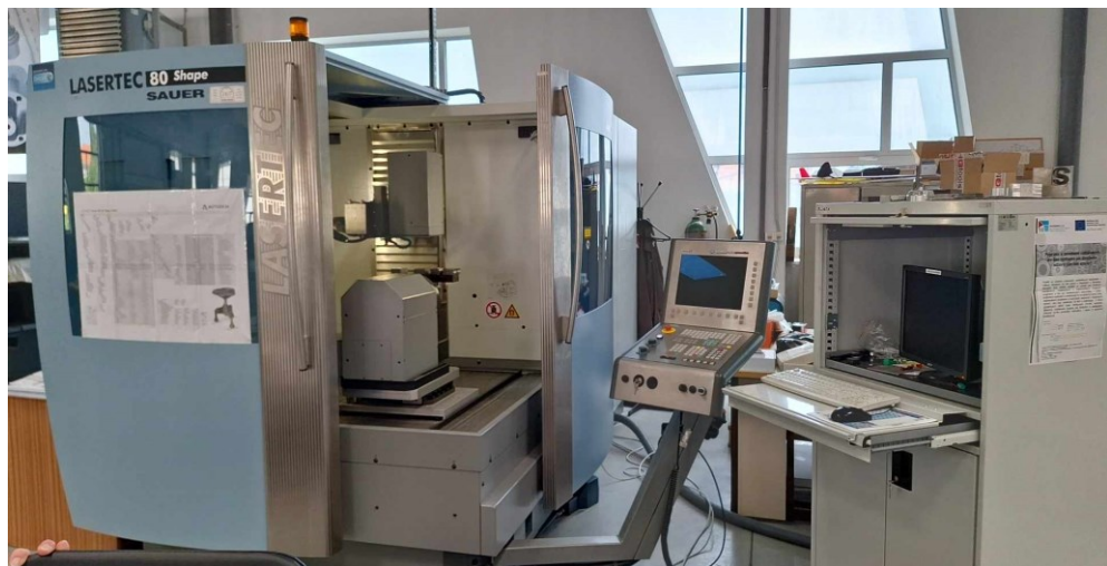
Obrázek 61 Vlákňový laser Sauer -Lasertec 80 Shape
