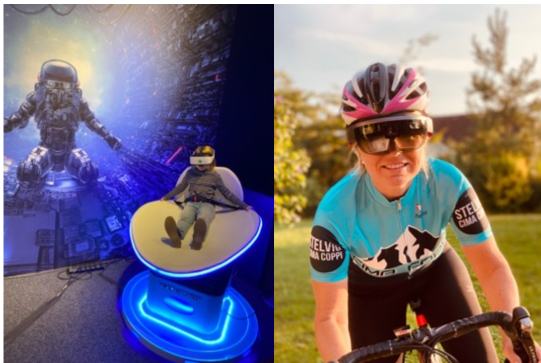
Obrázek 10 VR zážitek na pohyblivém křesle. Hololens s přenosem zvuku do spánkové kosti. Zdroj: archiv autorky.
