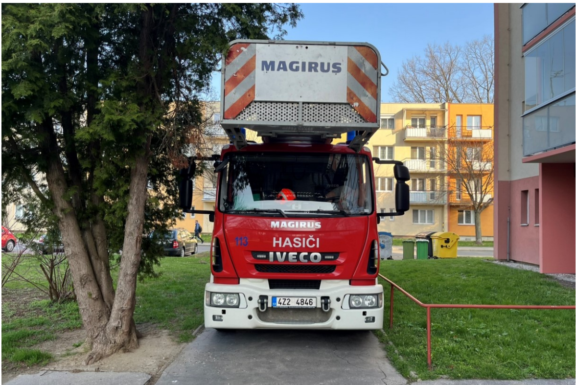
Obr. 9 – Prvky komplikující ustavení techniky u domu čísel popisných 1253 a 1254 (Vlastní, 2024)
