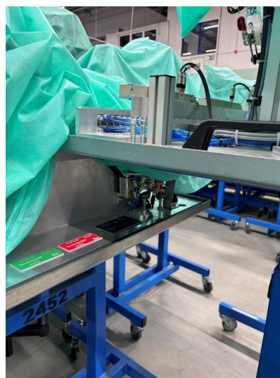
Obrázek 22 Špatné umístění přípravků (vlastní zpracování)
