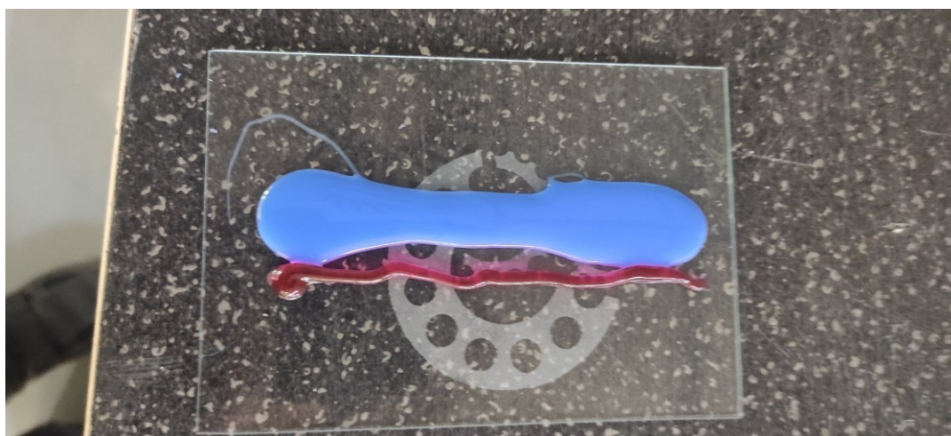
Obrázek 41 Ukázka katalyzátoru a silikonu v tekutém stavu
