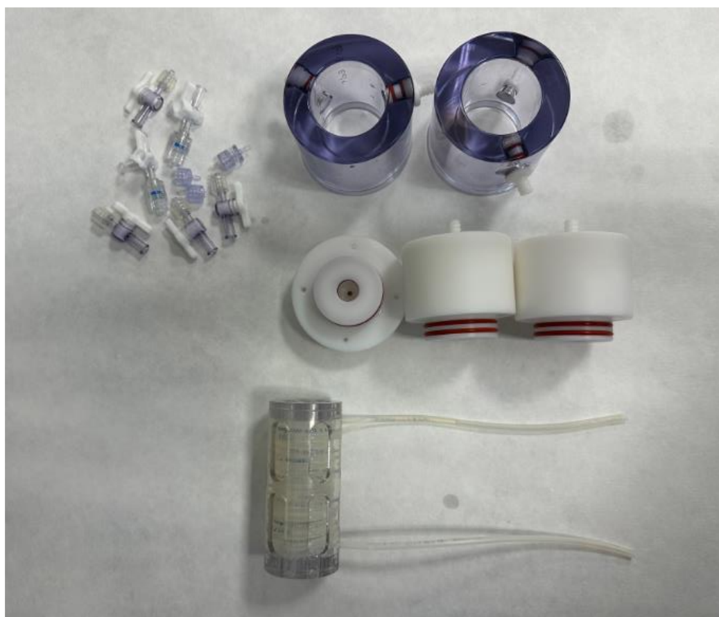
Obrázek 18 – Díly, ze kterých se skládá perfuzní rotační bioreaktor od společnosti Synthecon Incorporated, který byl použit v praktické části. Zdroj: Laboratoř buněčné biologie, Centrum polymerních systémů, Univerzita Tomáše Bati ve Zlíně (vlastní fotografie).
