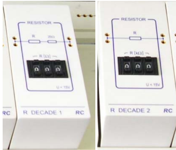
obr. 7.a. a obr.7.b. realizace odporových dekád v laboratoři
