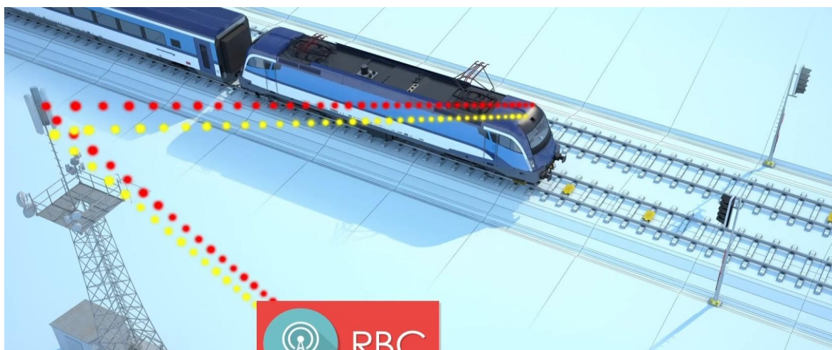
Obrázek 11 Komunikace mezi RBC a vlakem prostřednictvím BTS (SŽ, © 2024)
