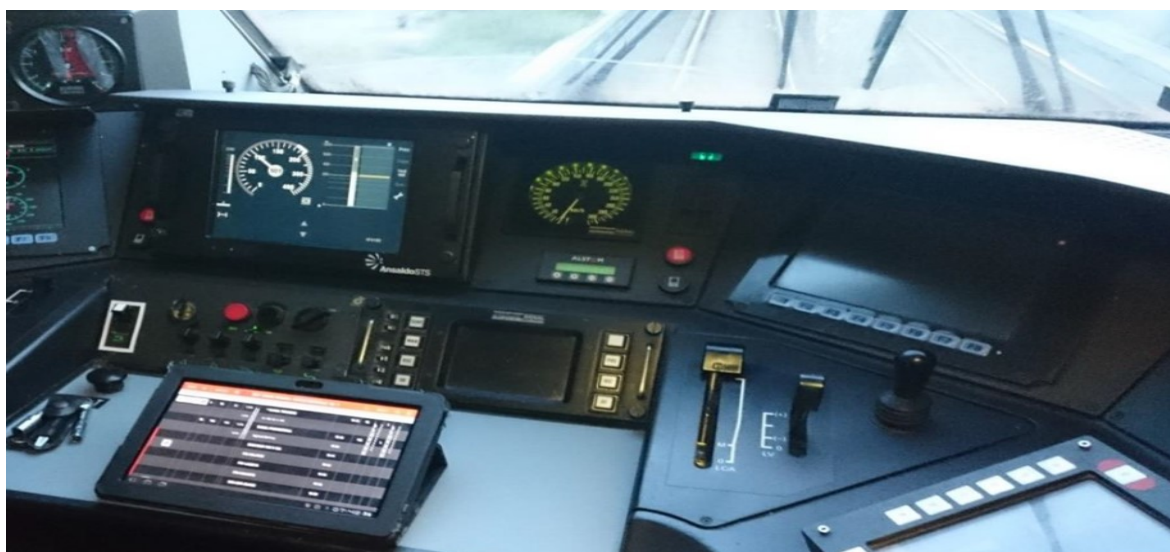
Obrázek 18 Stanoviště strojvedoucího na lokomotivě jednotka DMI (Reynolds et al., © 2020)
