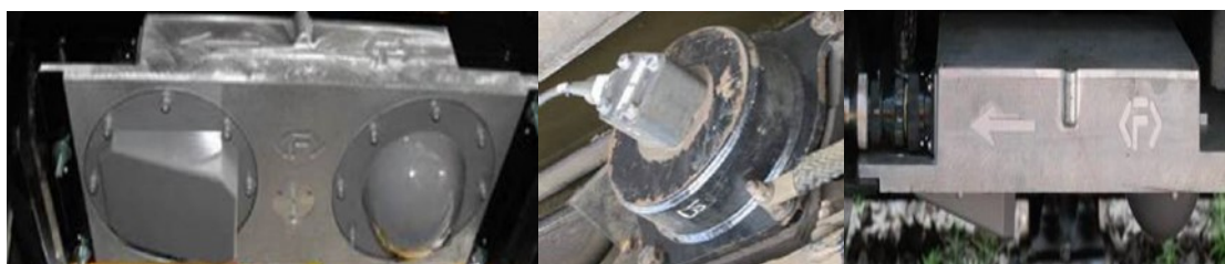
Obrázek 20 Dopplerův radar umístěný na podvozku lokomotivy (Reynolds et al., © 2020)
