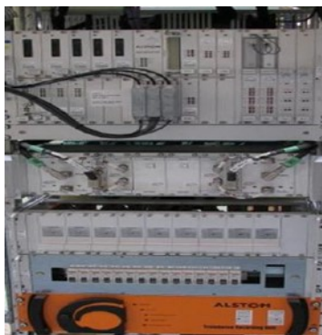
Obrázek 17 Jednotka JRU na lokomotivě (Reynolds et al., © 2020)
