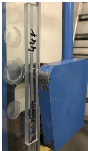
Obrázek 80. Test pevnosti lepeného spoje.
