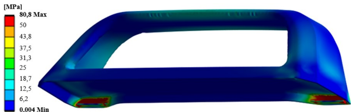
Obrázek 71. Výcvak přes krátké zácvaky – oblasti s napětím von Mises po úpravě.
