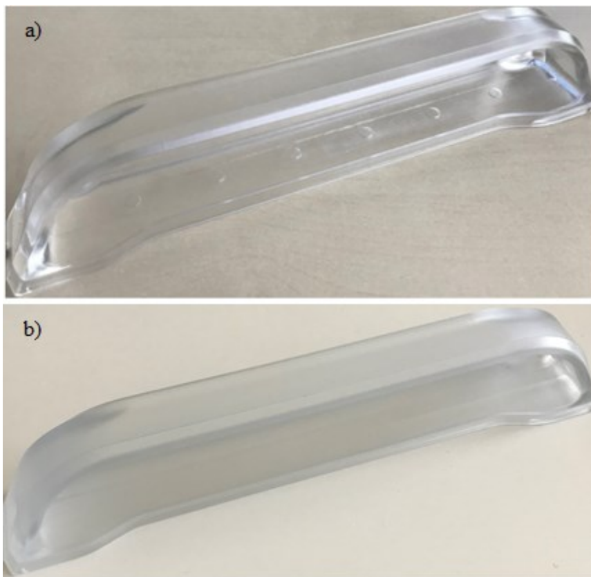
Obrázek 78. Výstřik madla z formy : a) před úpravou, b) po úpravě.
