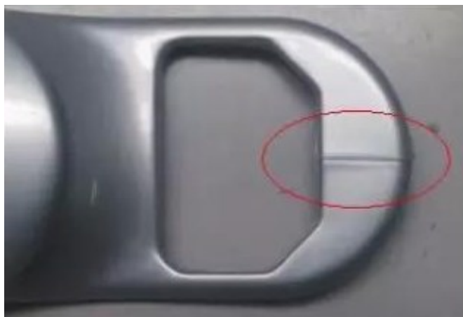
Obrázek 15. Příklad studeného spoje [27].
