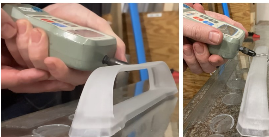
Obrázek 81. Nacvaknutí a vycvaknutí madla – bodové zatížení.
