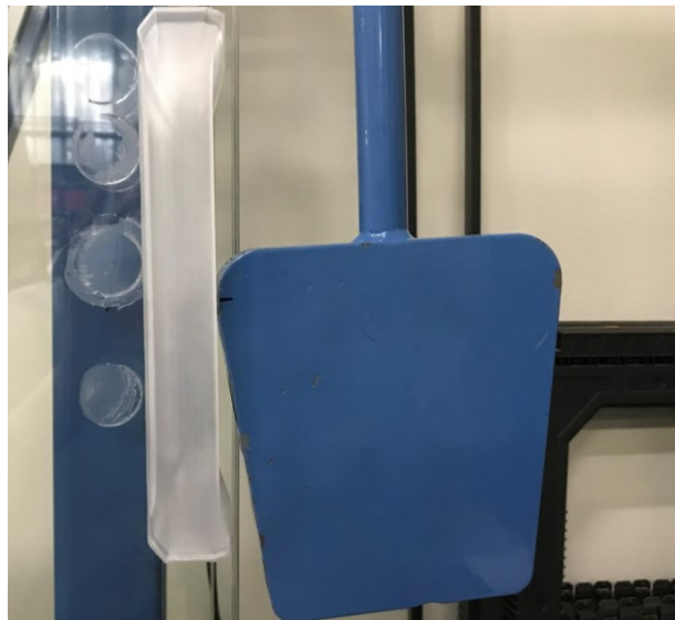
Obrázek 83. Testování madla na Charpyho kladivu.
