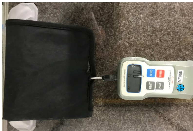
Obrázek 82. Nacvaknutí a vycvaknutí madla – plošné zatížení.
