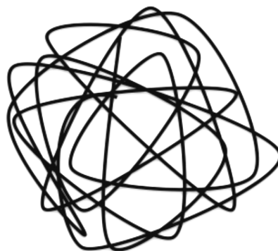
Obrázek 19 – Struktura amorfniho polymeru [33]
