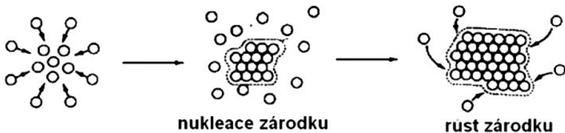
Obrázek 17 – Schéma krystalických zárodků a jejich růst [27]
