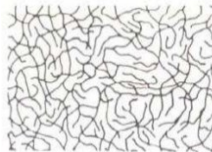
Obrázek 2 – Uspořádání makromolekul amorfních termoplastů [5]
