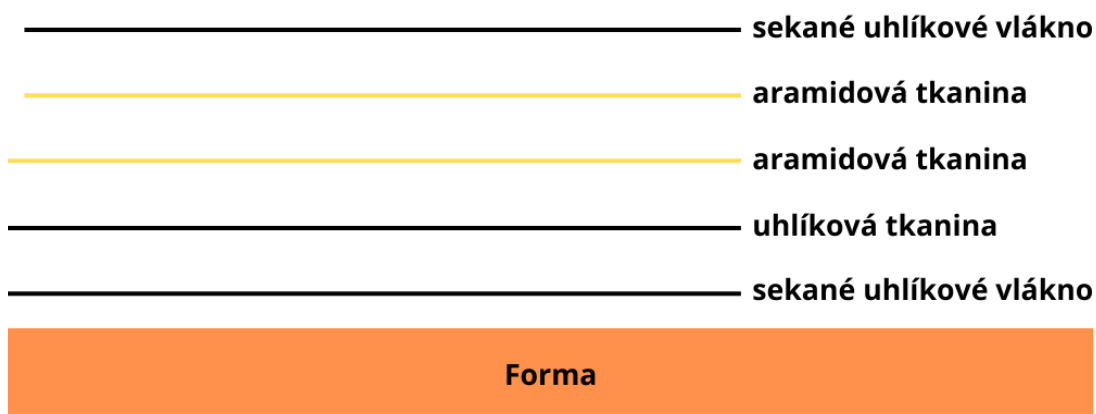
Obrázek 18 Materiálová skladba chrániče
