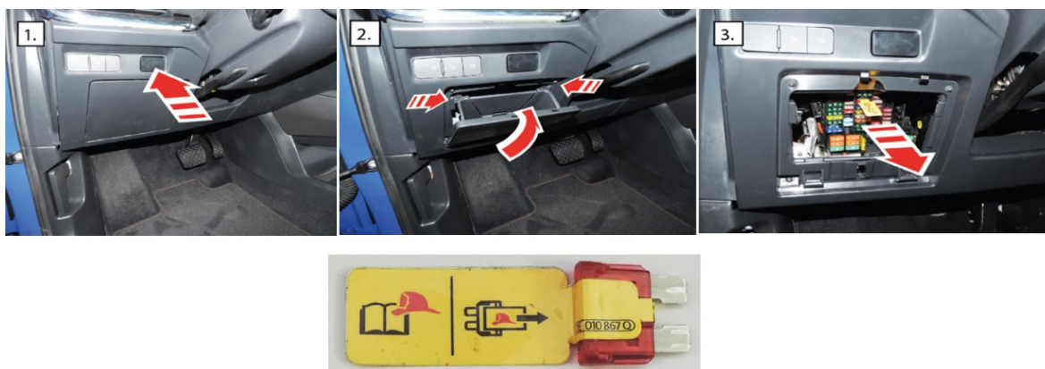
Obrázek 20 – Alternativní deaktivace vysokonapětového systému vozidla (ŠKODA ENYAQ COUPE iV (od 2023), 2023)
