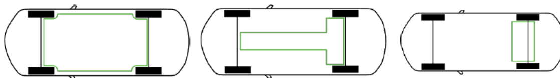
Obrázek 7 – Typy umístění baterií v podvozku vozidla (Bisschop et al., 2019)
