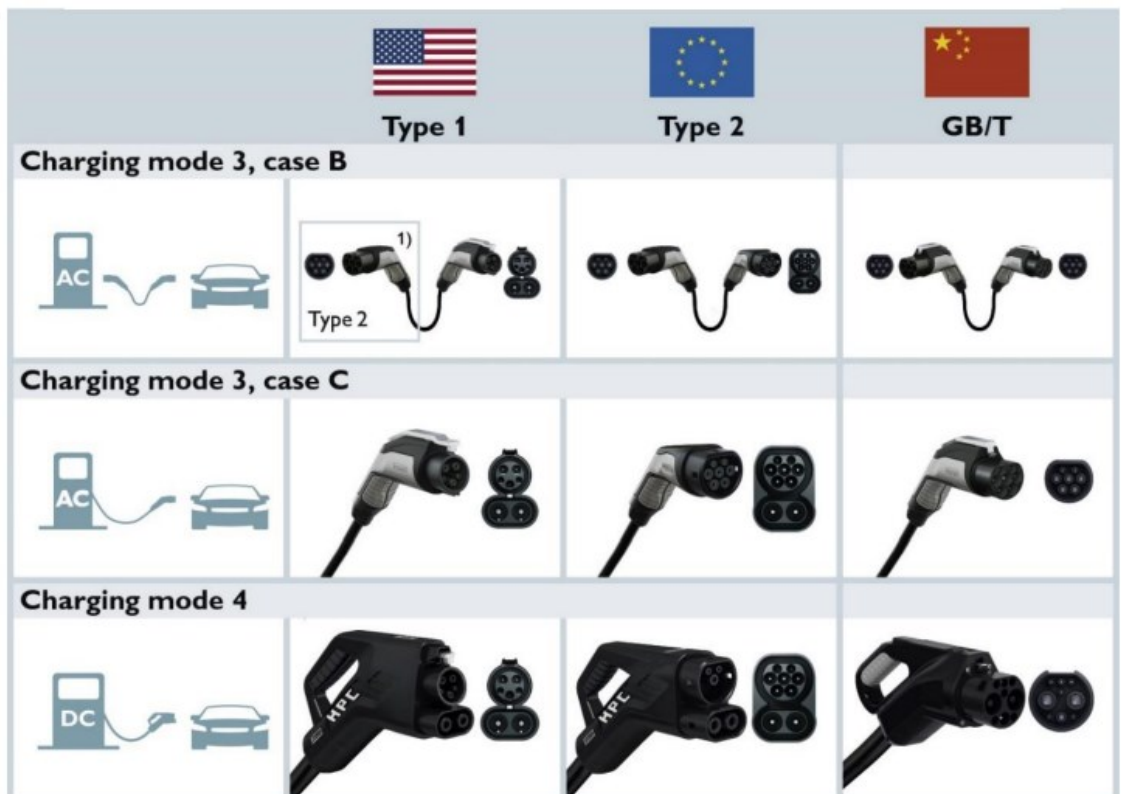
Obrázek 15 – Druhy nabíjecích konektorů (Malkovský et al., 2020)
