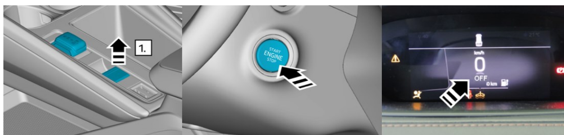
Obrázek 18 – Postup k znehybnění vozidla (ŠKODA ENYAQ COUPÉ iV (od 2023), 2023)
