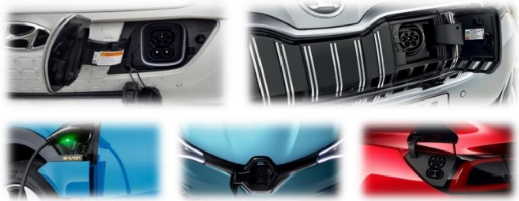
Obrázek 14 – Umístění konektorů (Malkovský et al., 2020)
