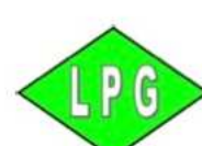
Obrázek 7 – Značení vozidel s pohonem LPG (MV-GŘ HZS ČR, 2017)
