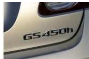
Obrázek 2 – Označení písmenem „h“ (GŘ HZS ČR, 2017)
