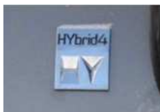
Obrázek 4 – Označení znakem hybridního pohonu (GŘ HZS ČR, 2017)
