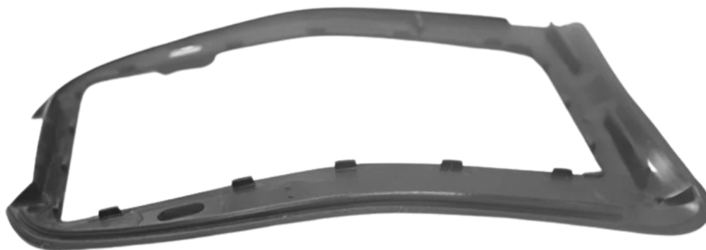
Obrázek 32. Zkroucený díl po vychladnutí [15].
