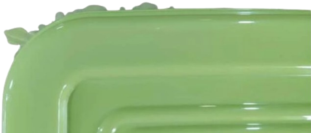
Obrázek 23. Přetoky na vstřikovaném díle [15].
