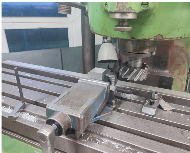
Obr. 48: Úhlování polotovaru na konzolové frézce FV20
