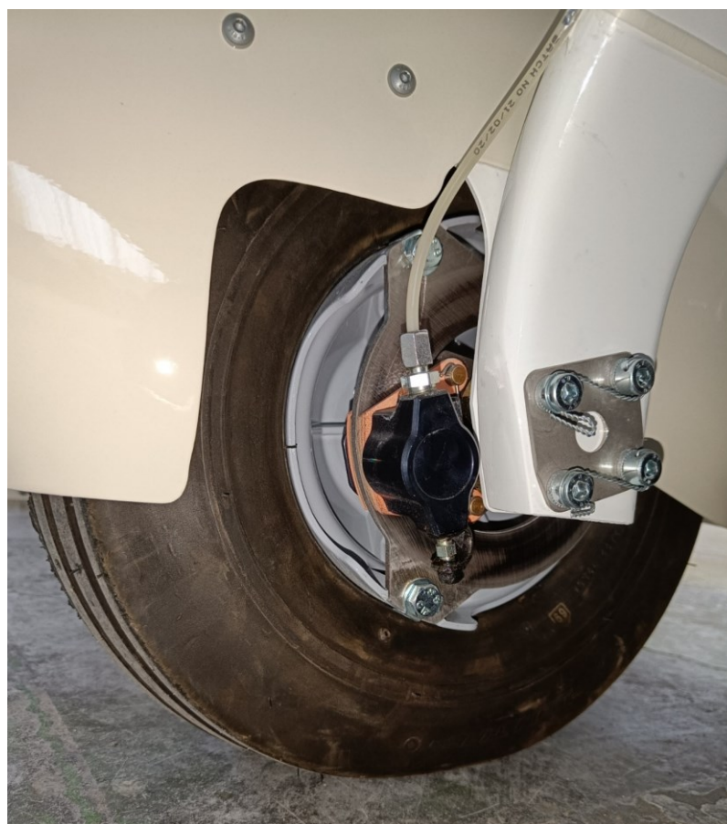
Obr. 52: Instalovaný brzdový třmen na podvozkové kolo letounu Harmony LSA
