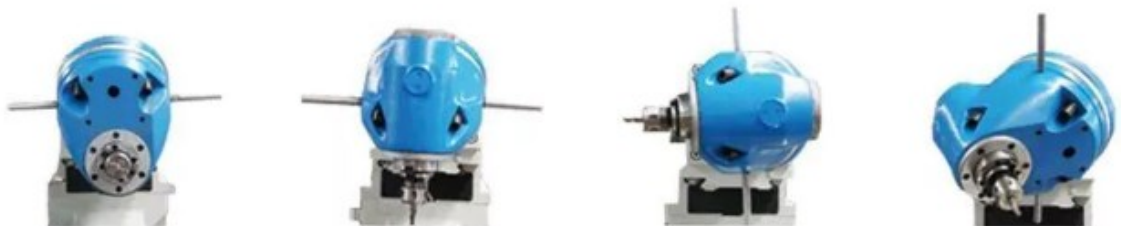
Obr. 11: Různá nastavení polohy vřetene univerzální frézky [12]
