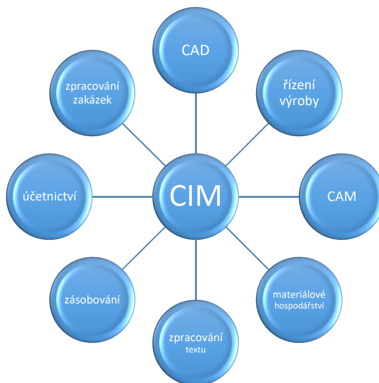
Obr. 27: Schéma výroby integrované počítačem [20]
