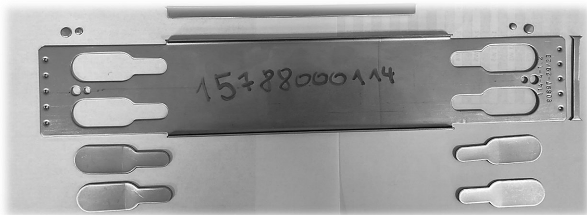
Obr. 29.: Příklad technického odpadu výroby přístřihu pro sponu RGF
