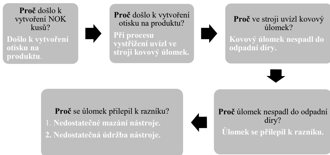
Obr. 46.: 5× proč pro nalezení kořenové příčiny vytvoření rýhy na produktu PPV
