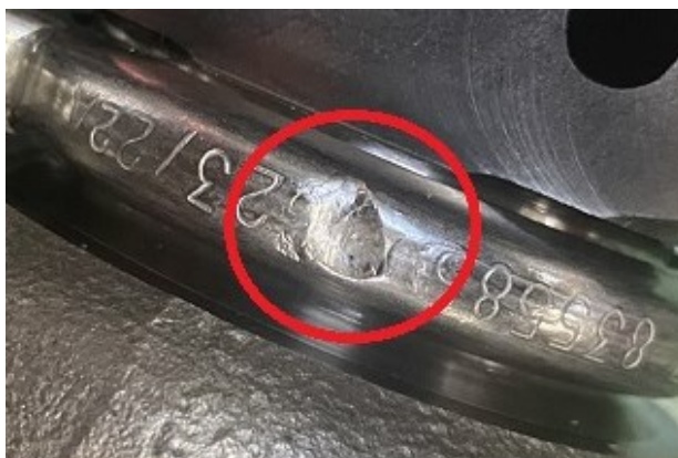
Obr. 44.: NOK kus produktu PPV s otiskovou vadou
