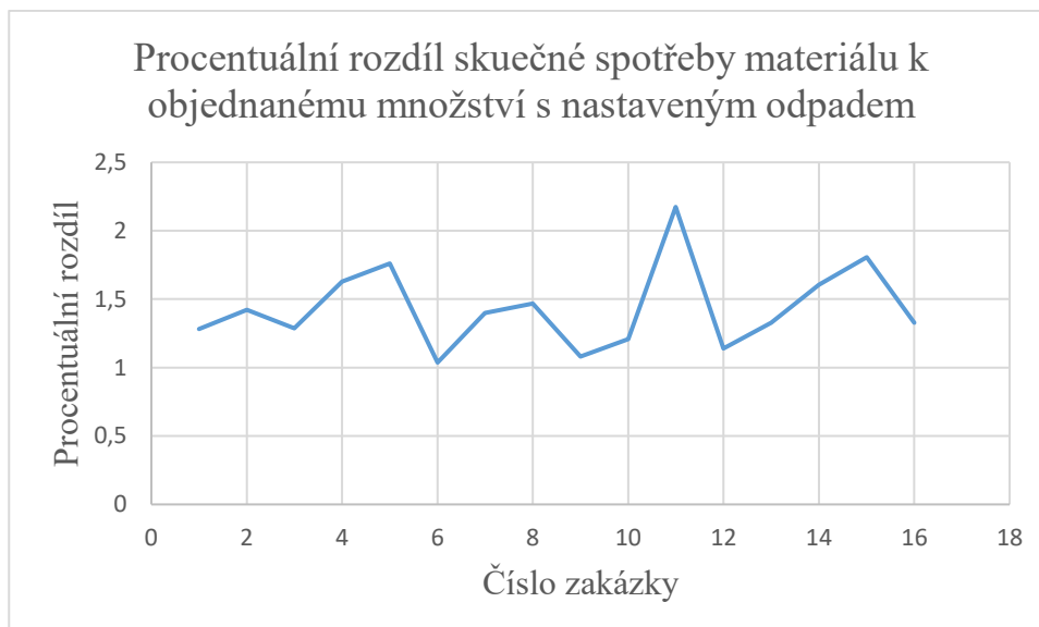
Obr. 33.: Procentuální rozdíl skutečné spotřeby materiálu proti objednanému množství s nastaveným odpadem
