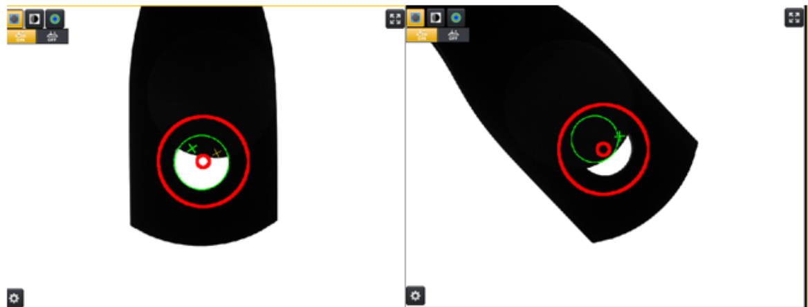
Obrázek 49 Ukázka detekování vady díry stabilizátoru
