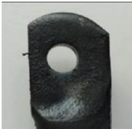
Obrázek 25 Defekt tvaru konce stabilizátoru
