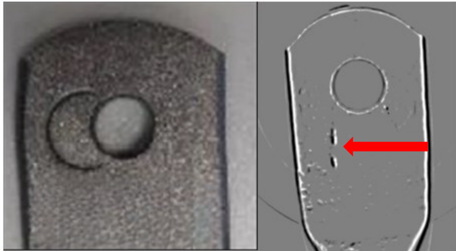
Obrázek 24 Defekt na ploše lisovaného konce stabilizátoru
