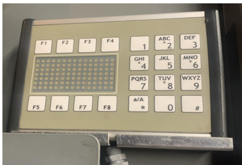
Obrázek 13 Displej pro otevření vrat z vozidla [vlastní]
