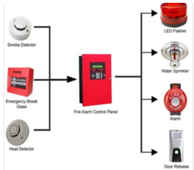
Obrázek 6 Elektronická požární signalizace (Elektronická požární signalizace, ©2022)
