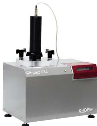
Obrázek 2: Reofermentometr Rheo F4 Chopin Technologies [40]
