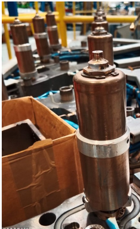
Obrázek 17 Příklad vyhřívané trysky
