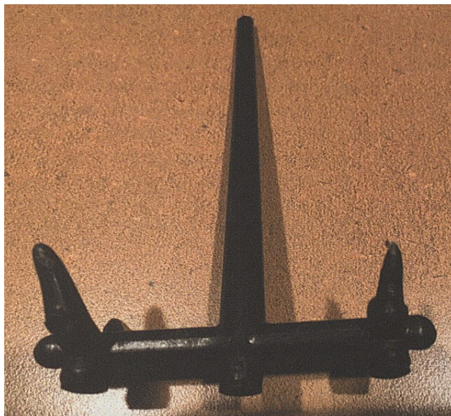
Obrázek 5 Příklad odpadu – vtokové ústí [17]
