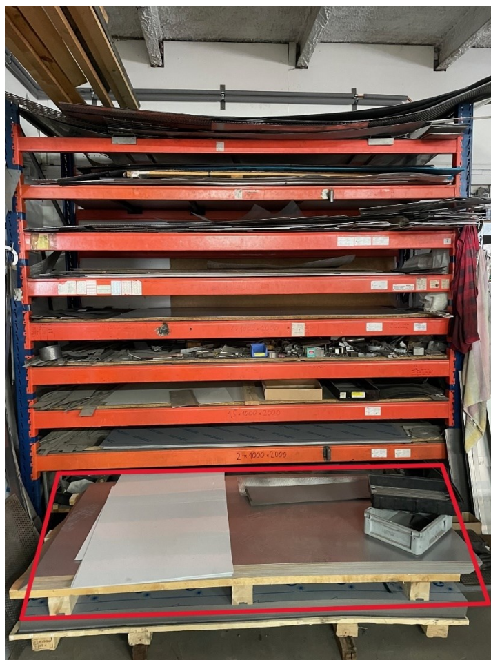
Obrázek 31: Nevhodné uskladnění materiálu pro stříhací proces (vlastní zpracování)
