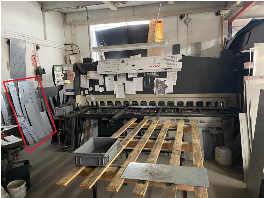
Obrázek 32: Nevhodné ukládání odštížků v procesu stříhání (vlastní zpracování)
