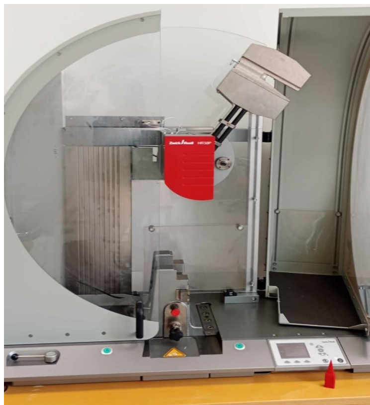
Obrázek 17. Charpyho kladivo HIT50P [vlastní zdroj]
