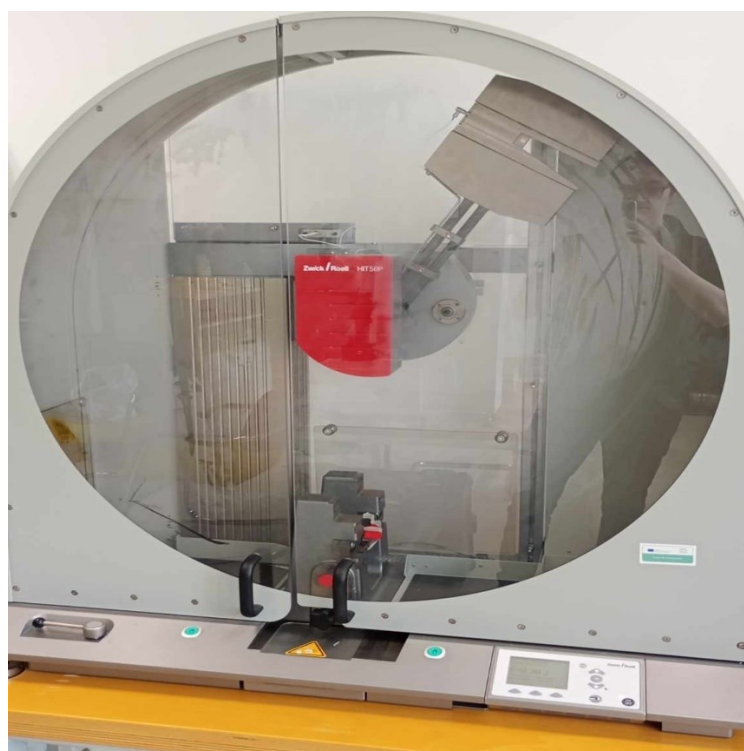
Obrázek 18. Testování na Charpyho kladivu [vlastní zdroj]
