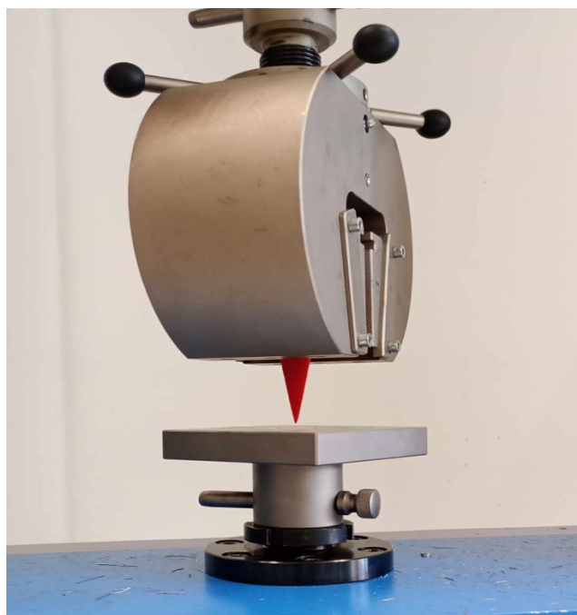
Obrázek 20. Tlaková zkouška předmětu [vlastní zdroj]
