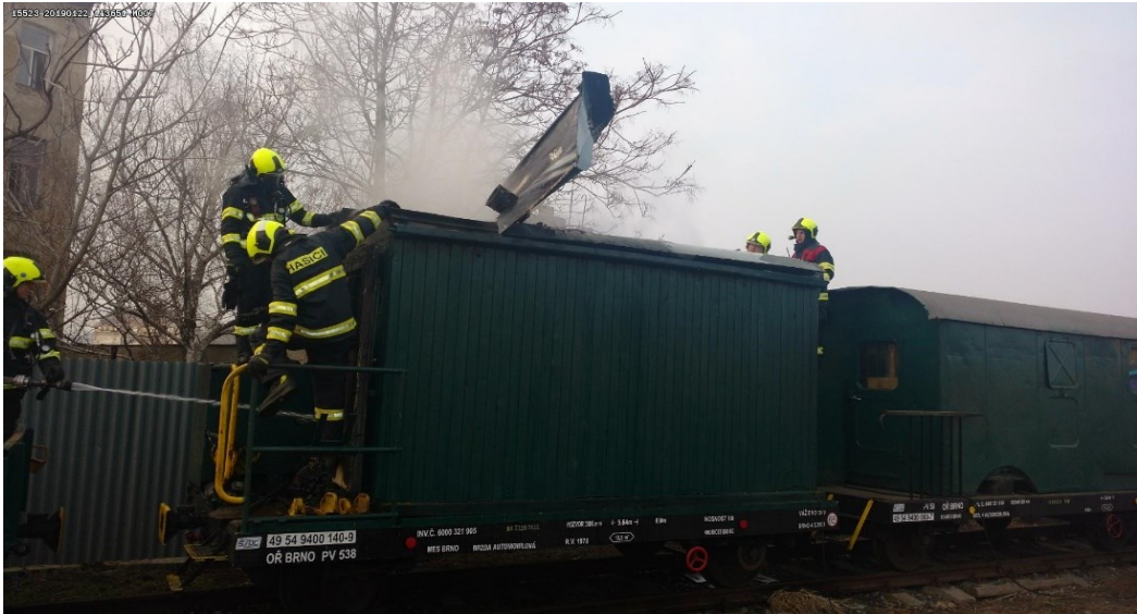
Obrázek 6 Vytvoření evakuační cesty ve střeše vozu (HZS SŽ Přerov, 2019)
