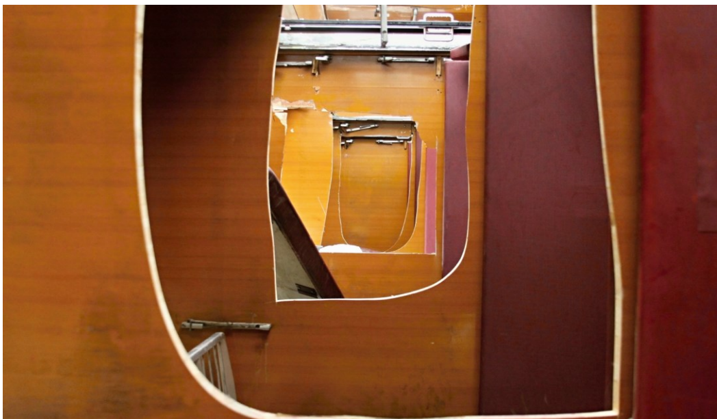
Obrázek 7 Vytvoření evakuační cesty uvnitř vagónu (HZS SŽ Přerov, 2014)
