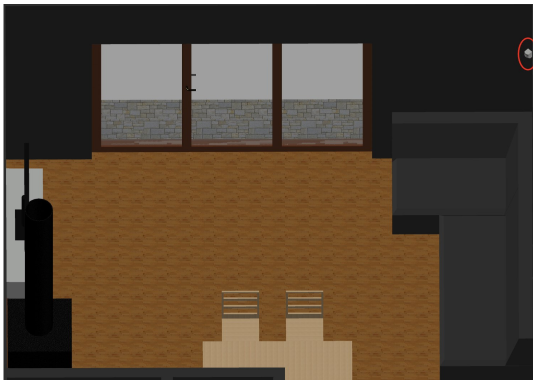
Obrázek 37 Umístění PIR detektorů 2/2 [Vlastní zdroj]
