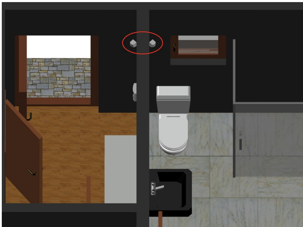
Obrázek 36 Umístění PIR detektorů 1/2 [Vlastní zdroj]
