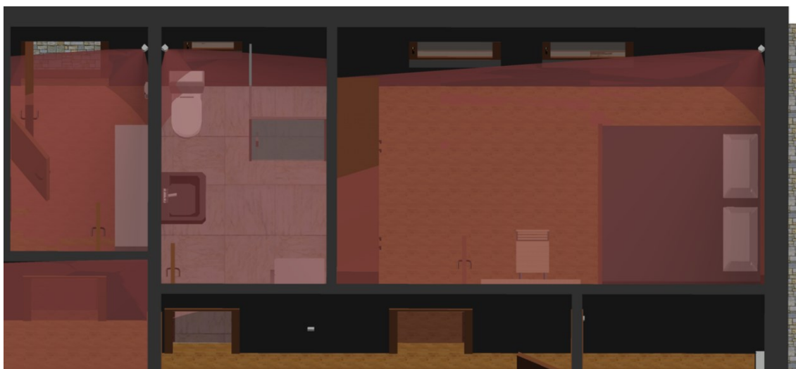
Obrázek 49 Ukázka pokrytí PIR detektory 1/3 [Vlastní zdroj]
